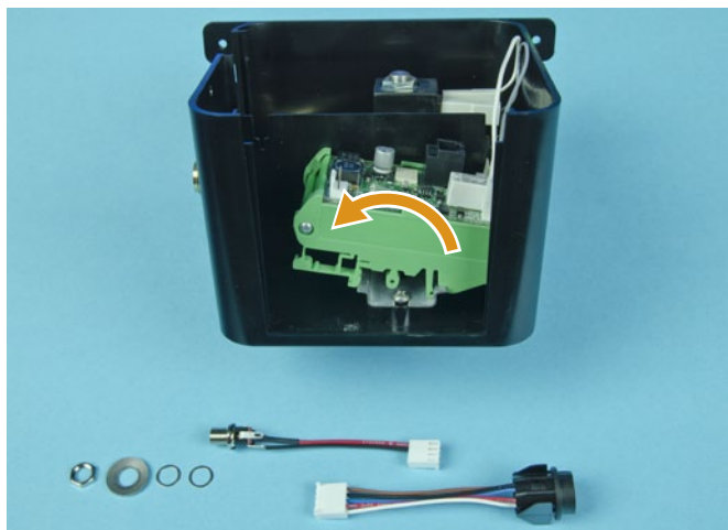
Montar el sistema de control electrónico con zócalo
