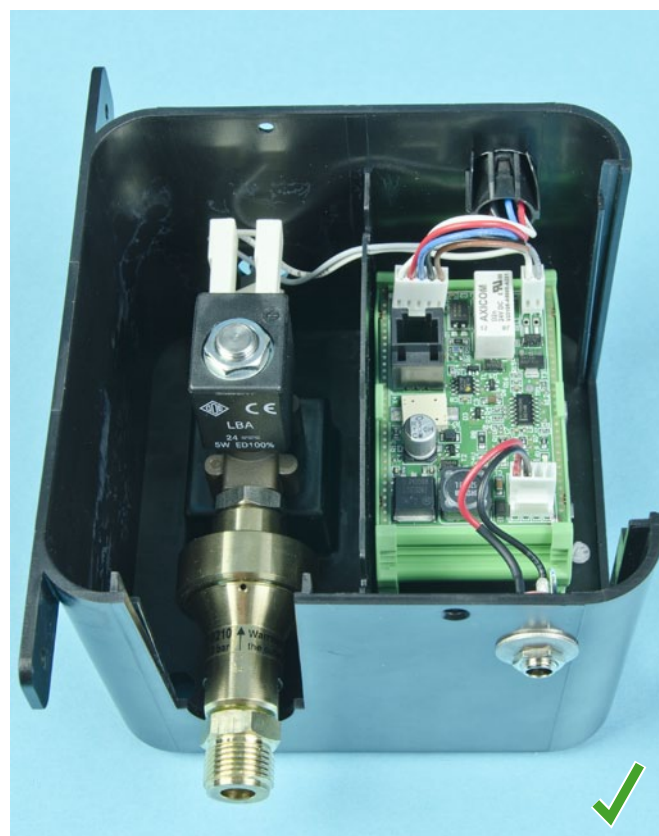
Carcasa de conexión con el nuevo sistema electrónico
