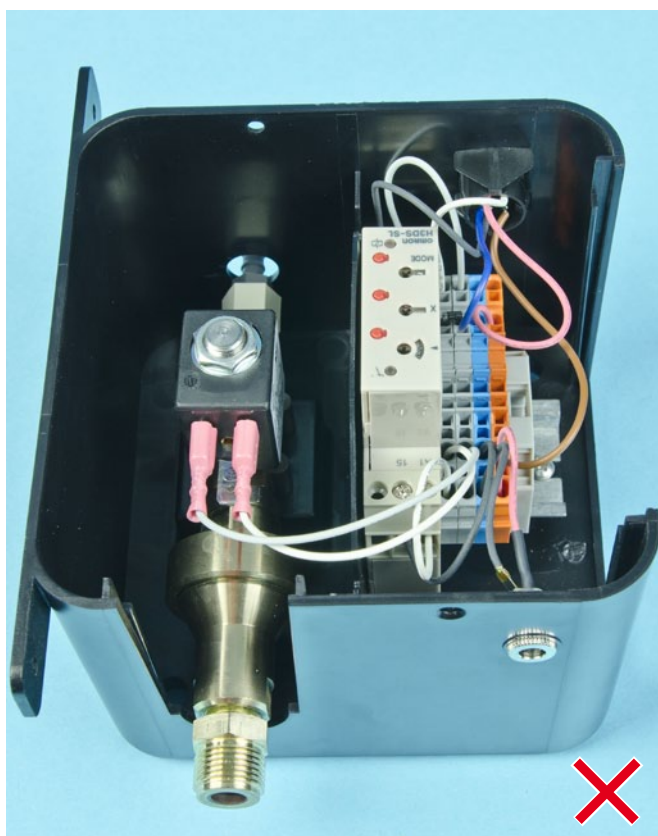
Carcasa de conexión con el sistema electrónico anterior
