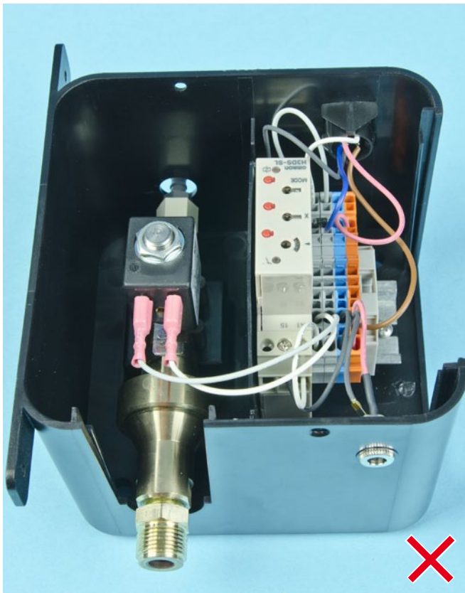
Anschlussgehäuse mit alter Elektronik
