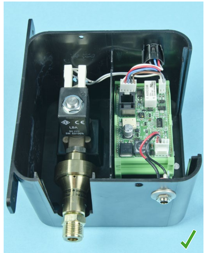
Anschlussgehäuse mit neuer Elektronik
