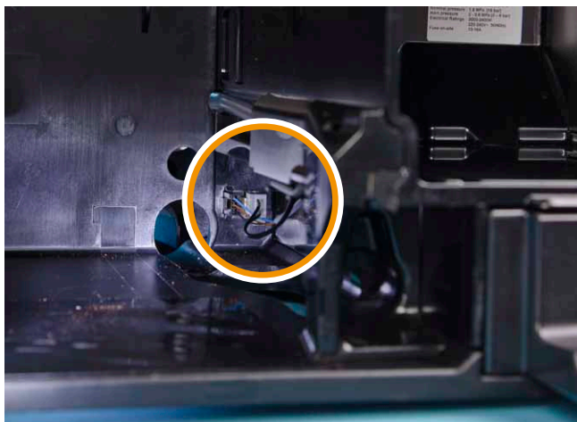
Stecker der Sensoren ausstecken Disconnecting the sensor plugs Débrancher les connecteurs des capteurs Desenchufe el conector de los sensores.
