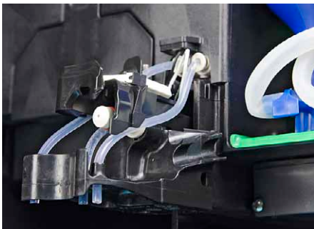
Getränkeauslauf ohne Abdeckhaube, seitliche Ansicht Beverage outlet without cover hood, side view. Sortie des boissons sans couvercle, vue de côté Salida de bebida sin cubierta protectora, vista lateral.
