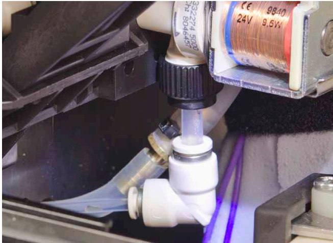
Altes Magnetventil mit Winkel Old solenoid valve with elbow fitting Ancienne électrovanne coudée Electroválvula anterior con codo
