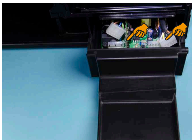
Einschub Taktnetzteil Removing the integrated power supply insert. Retirer le compartiment du transfo synchrone Extraiga la fuente de alimentación sincronizada insertable.
