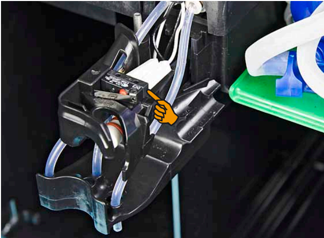
Getränkerauslauf ohne Abdeckhaube, Ansicht von oben. Korrekter Sitz Mikroschalter
