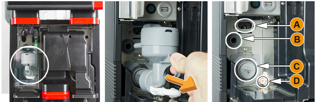
Şekil: Karıştırıcı kabının sökülmesi
