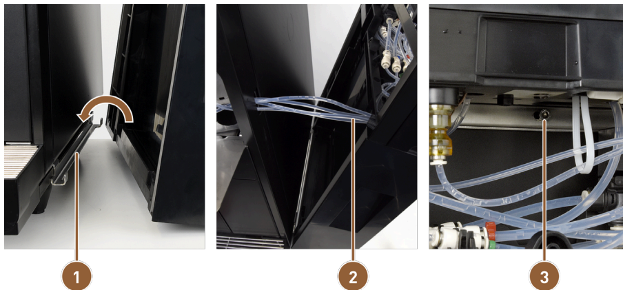
Fig.: Fijación de la unidad ProCare a la máquina
