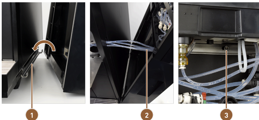
Фигура: Фиксиране на модула ProCare към машината
