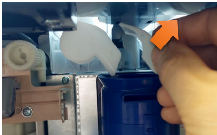
Verwijder in de machine het kapje van het uitlooppijpe. Verwijder eventueel de mixerbeker voor meer ruimte.
