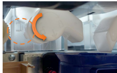
Draai het pijpje iets omhoog. Het wordt daardoor ontgrendeld.
