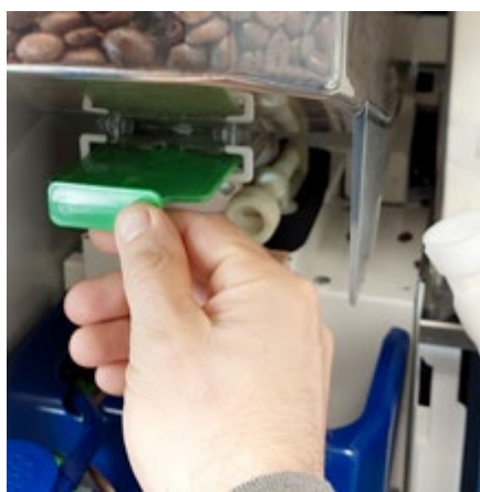
Druk de groene schuif van de bonenhouder naar achteren, om de uitloop te sluiten.
